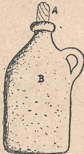
Fig. 10 — Murrão. A — Pavio de tarrafa ou estôpa. B — Butijão de genebra 'Fokin' onde é colocado o querozene.
